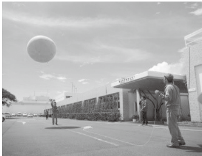
高層気球を用いた気象観測の様子
